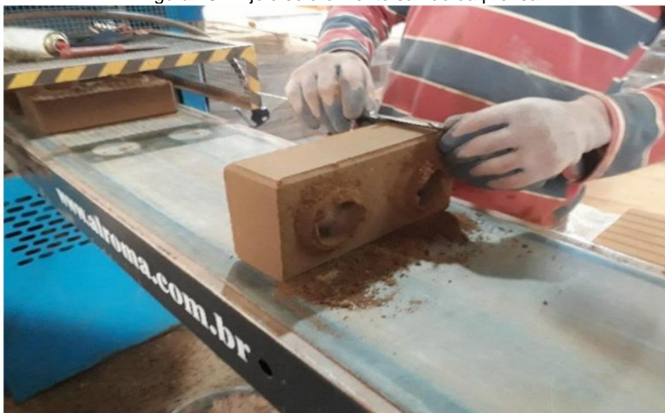
Figura 26 - Tijolo solo-cimento saindo da prensa
