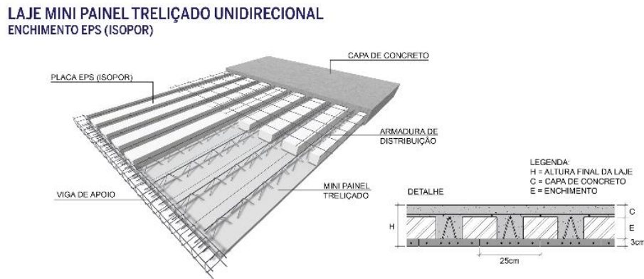
Imagem 42 – Sistema de laje treliçado unidirecional.
