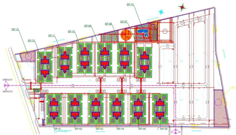
Figura 12 – Planta de situação dos furos de sondagem
