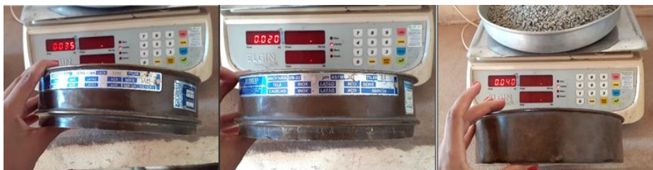
Figura 16: Peneiramento da amostra de maneira manual.
