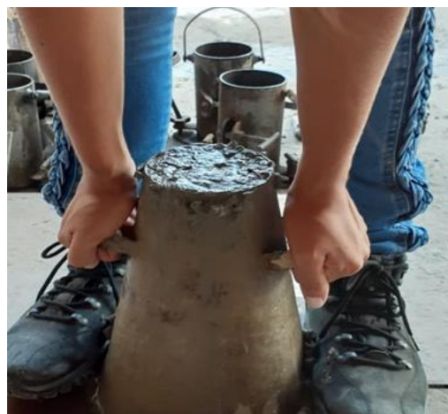
Figura 21: Retirada do abatimento do concreto.
