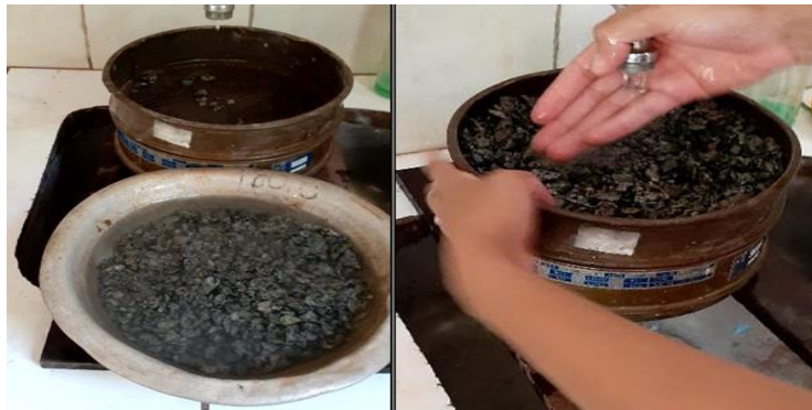
Figura 18: Retirada do material pulverulento da brita 0.
