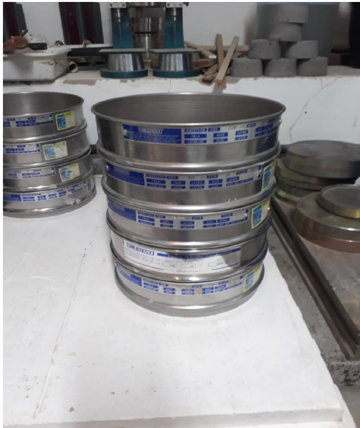
Figura 29 – Peneiras a serem utilizadas nos ensaios de granulometria.
