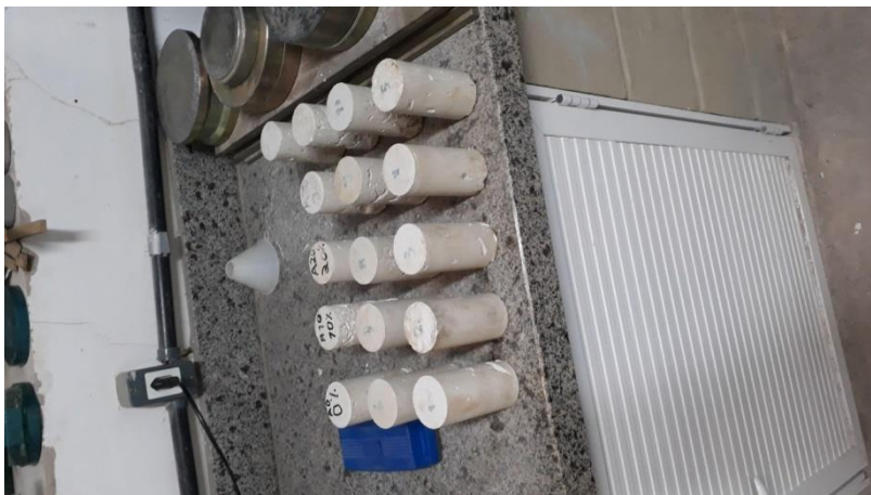
Figura 44 – Corpo de prova de gesso para as amostras A, B e C.
