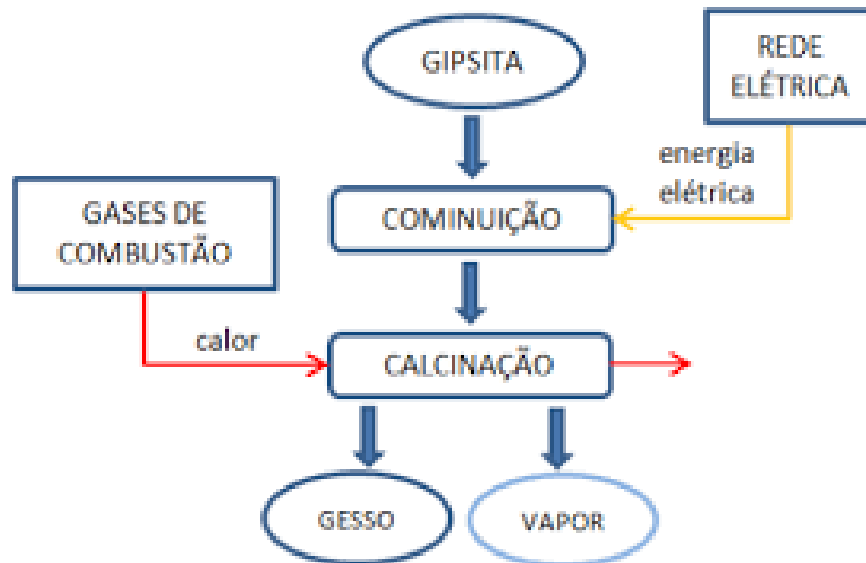
Figura 6 – Fluxograma do processo produtivo do gesso.
