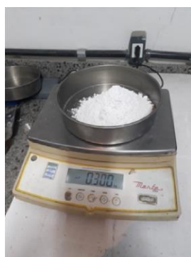
Figura 31 – Pesagem da amostra 300g para realizar os ensaios.
