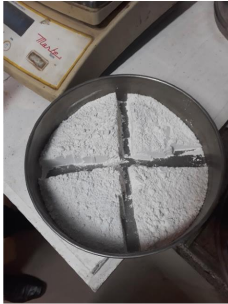
Figura 32 – Quarterizar conforme NBR 12127 para os ensaios.
