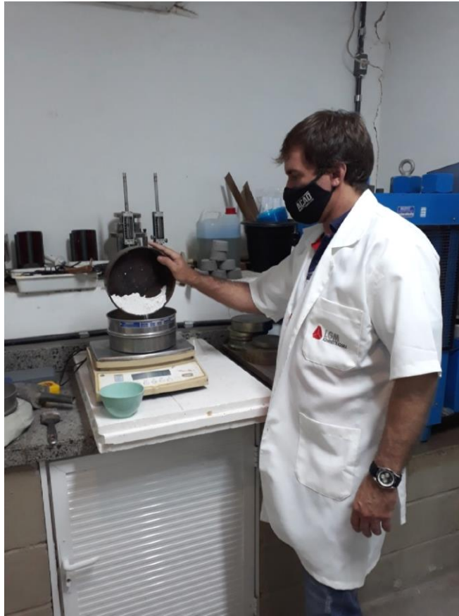
Figura 30 – Procedimento de pesagem ensaios de granulometria.
