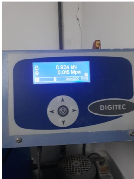
Figura 41 – Resultado do aparelho SOLOTEST amostra C com 24 horas.
