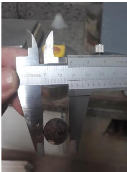
Figura 38 – Medição da esfera teste dureza com paquímetro.
