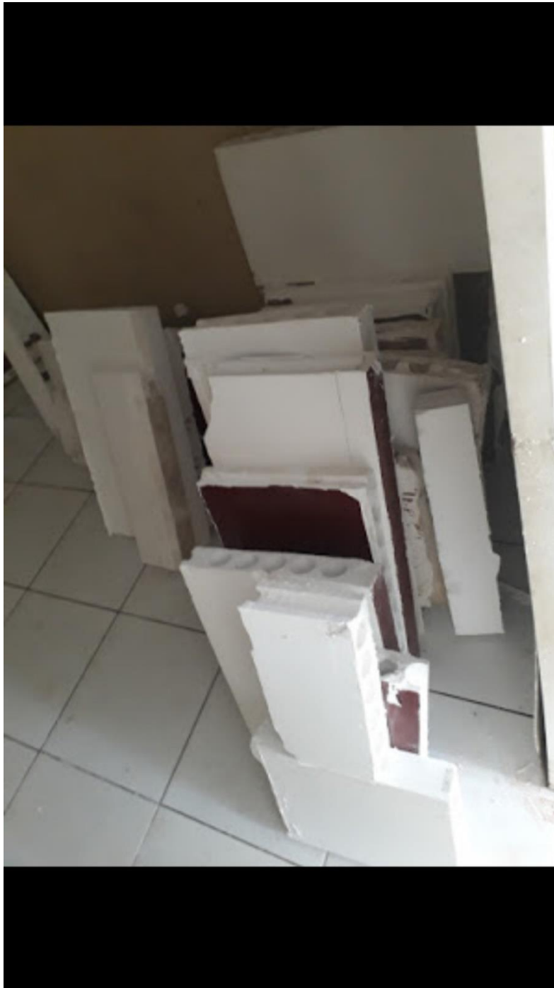
Figura 15 – Resíduo de placas de gesso.
