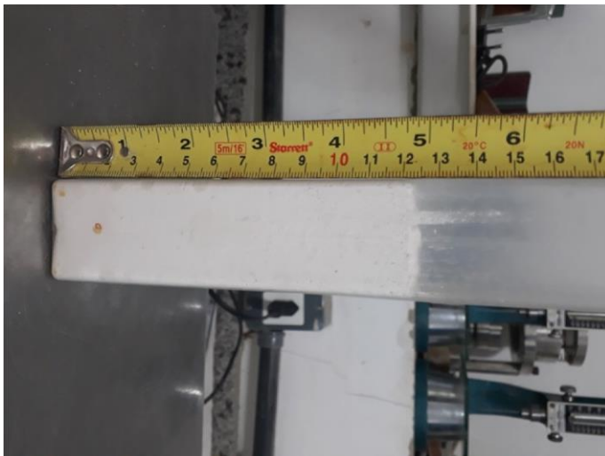
Figura 33 – Medição recipiente massa unitária 12 cm.
