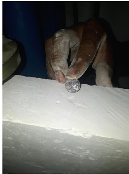
Figura 42 – Teste de dureza causando ondulação no gesso.
