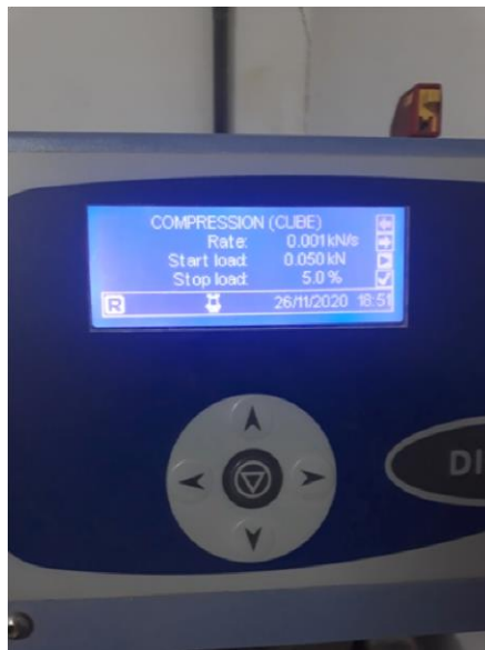
Figura 39 – Configuração aparelho SOLOTEST compressão força 50N.
