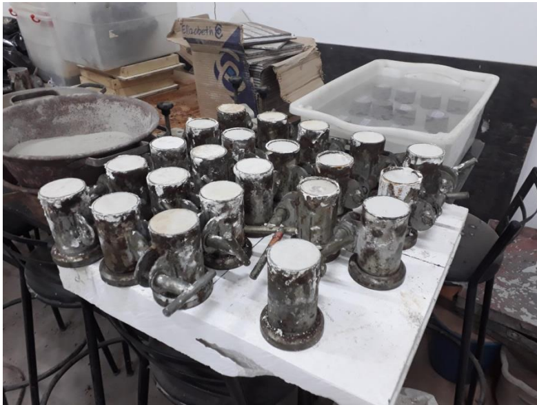
Figura 43 – Molde corpo de prova de gesso para as amostras A, B e C.
