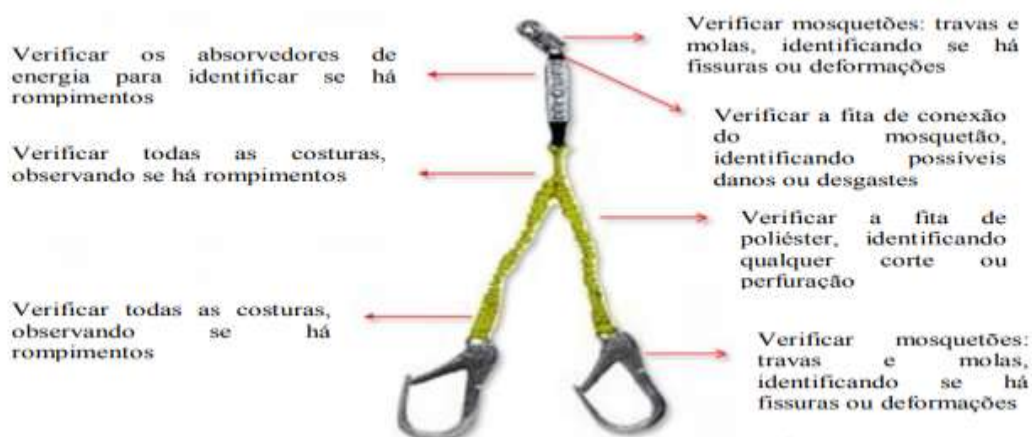
Figura 12 – Inspeção do talabarte
