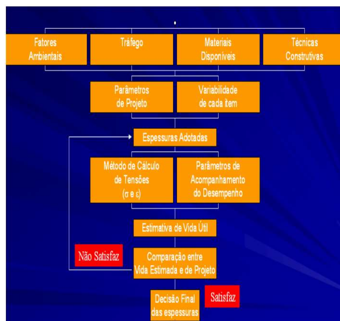
Figura 7 - Fluxograma de um método mecanístico de dimensionamento de pavimentos asfálticos
