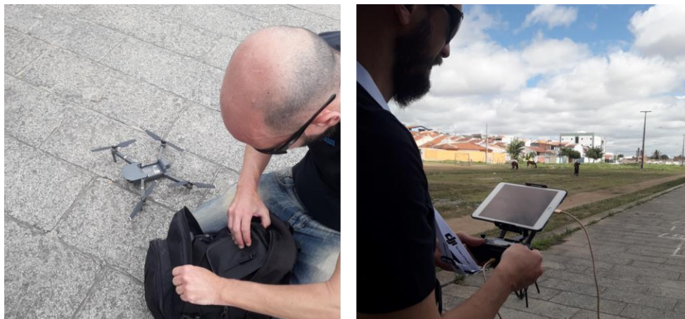
Figura 6: Drone, controle e tablet utilizados no levantamento.
