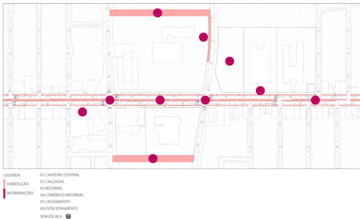
Figura 68 - Planta de Demolição.
