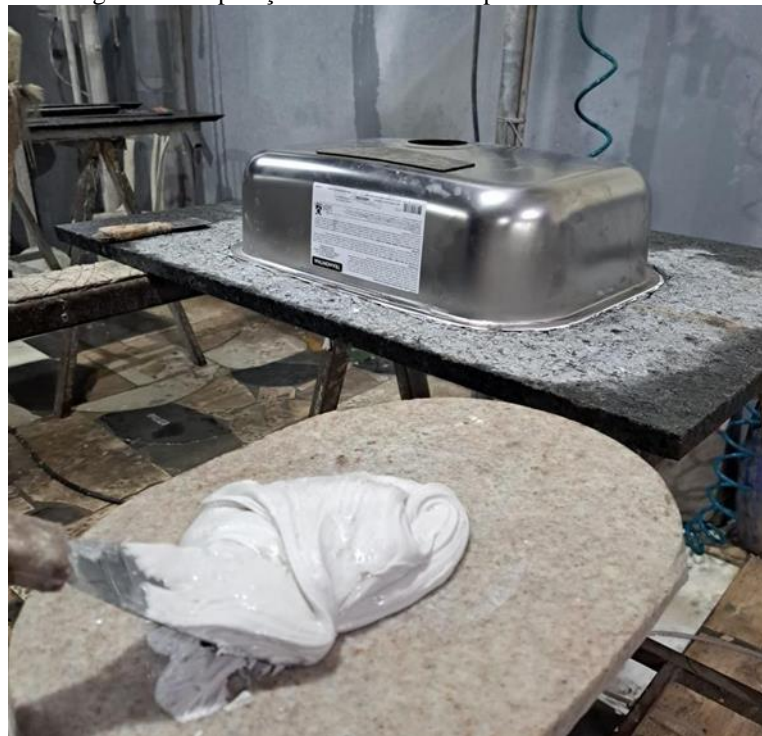
Figura 5 - Preparação da cola - uso do pó industrial e resina
