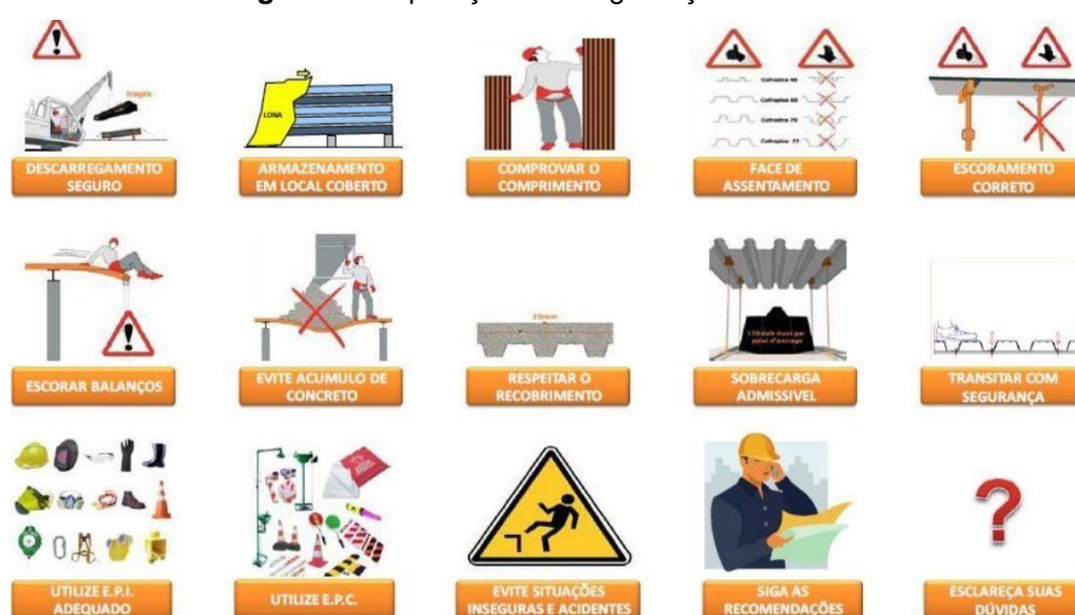
Figura 18 – operações de segurança no canteiro.
