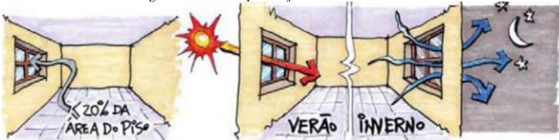
Figura 18: Distribuição das janelas no ambiente interno
