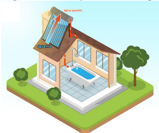
Figura 2: Sistema de aquecimento solar de água
