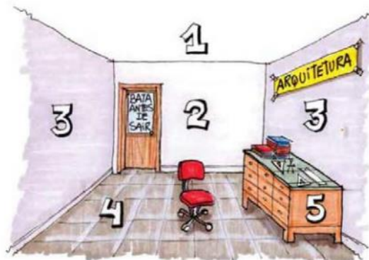
Figura 17: Hierarquia para refletância ideal do ambiente interno em função da posição da janela
