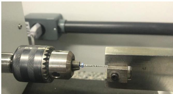
Figura 1. Dispositivo empregado no ensaio de torção
