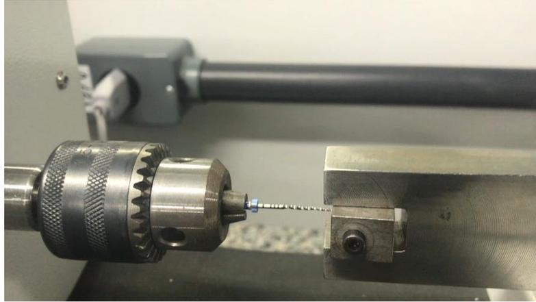
Figura 1. Dispositivo empregado no ensaio de torção
