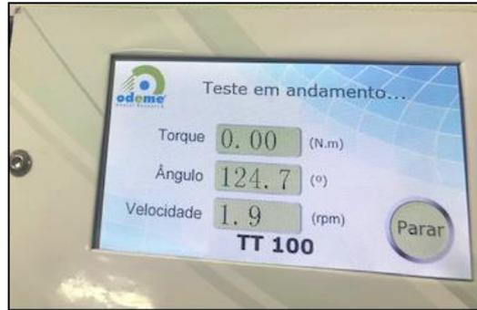
Figura 2. Visor do torquímetro mostrando a velocidade, torque e o ângulo máximo de torção.
