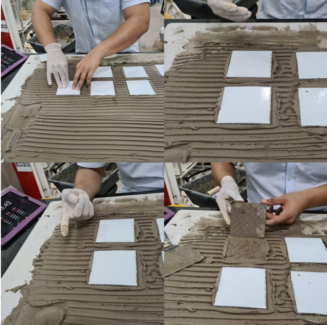
Figura 21: Ensaio Assentamento Cerâmico aos 20min
