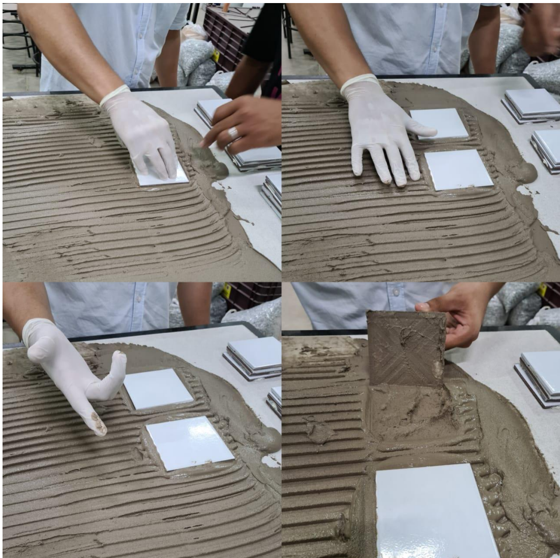
Figura 17: Ensaio Assentamento Cerâmico aos 2min30s
