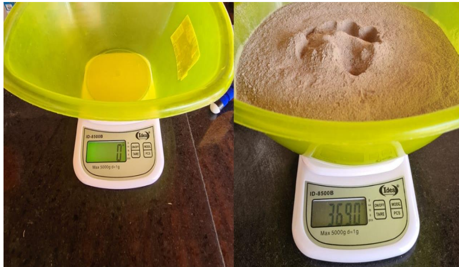
Figura 28: Dosagem da Argamassa colante Industrializada para Ensaio In Loco
