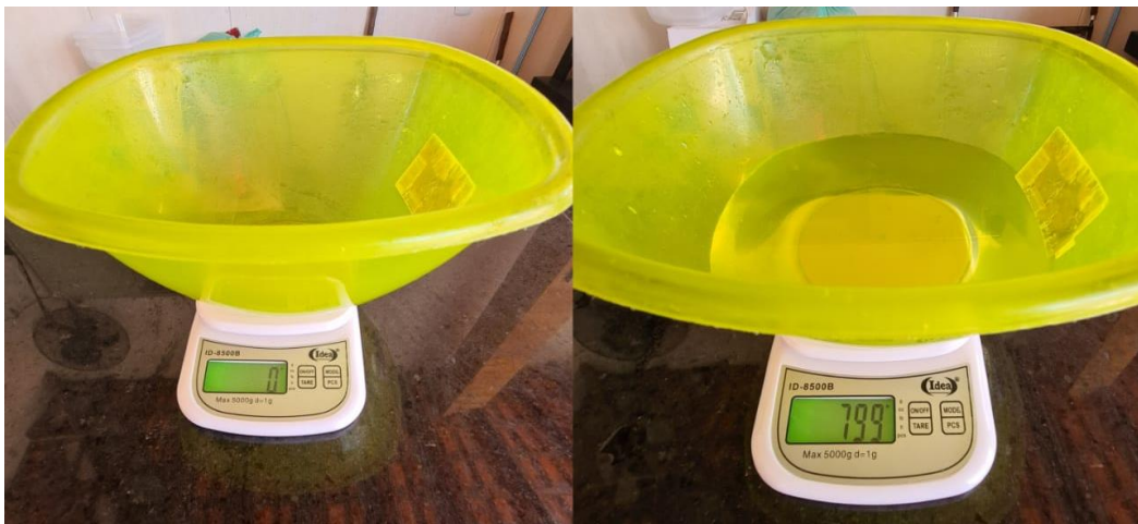
Figura 27: Dosagem da Água de Amassamento para Ensaio In Loco
