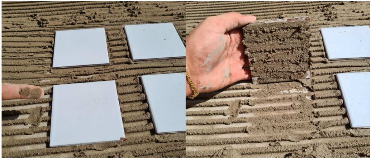
Figura 33: Ensaio Assentamento Cerâmico In Loco aos 4min
