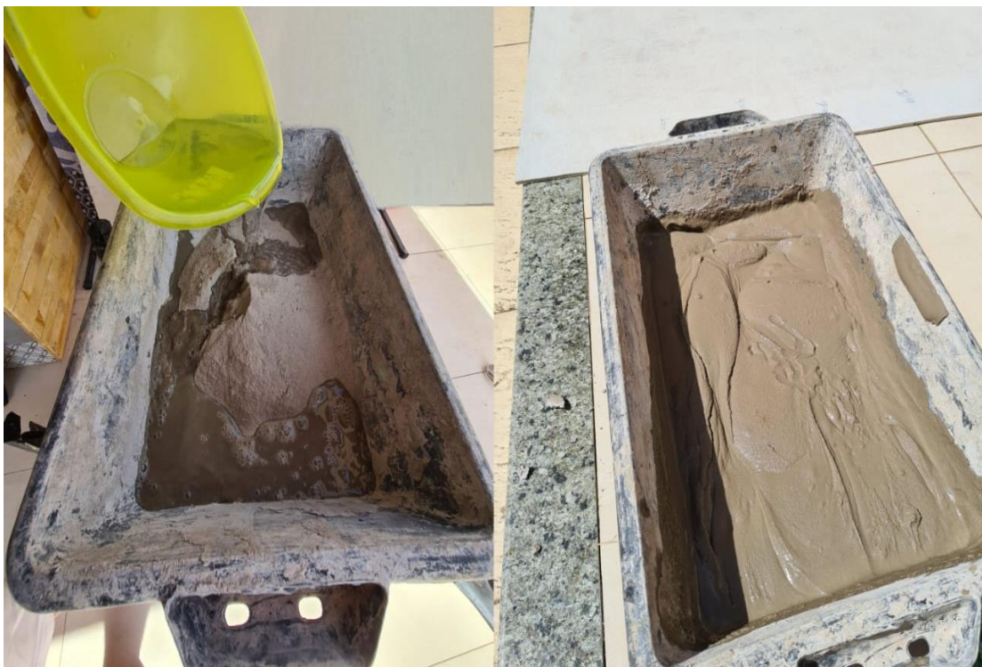
Figura 30: Adição de Água e Mistura à Argamassa Colante para Ensaio In Loco
