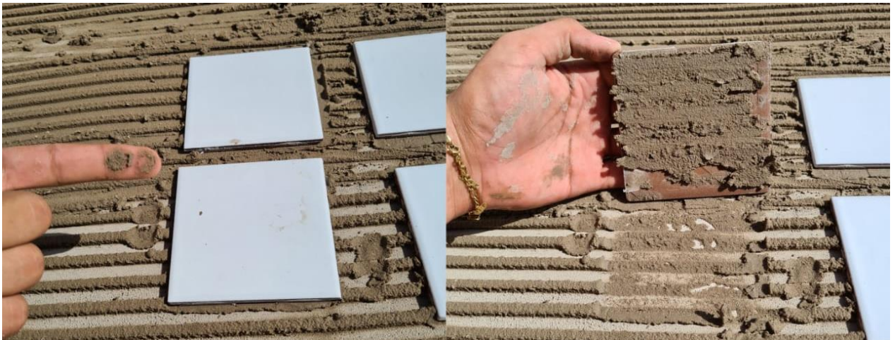
Figura 34: Ensaio Assentamento Cerâmico In Loco aos 7min
