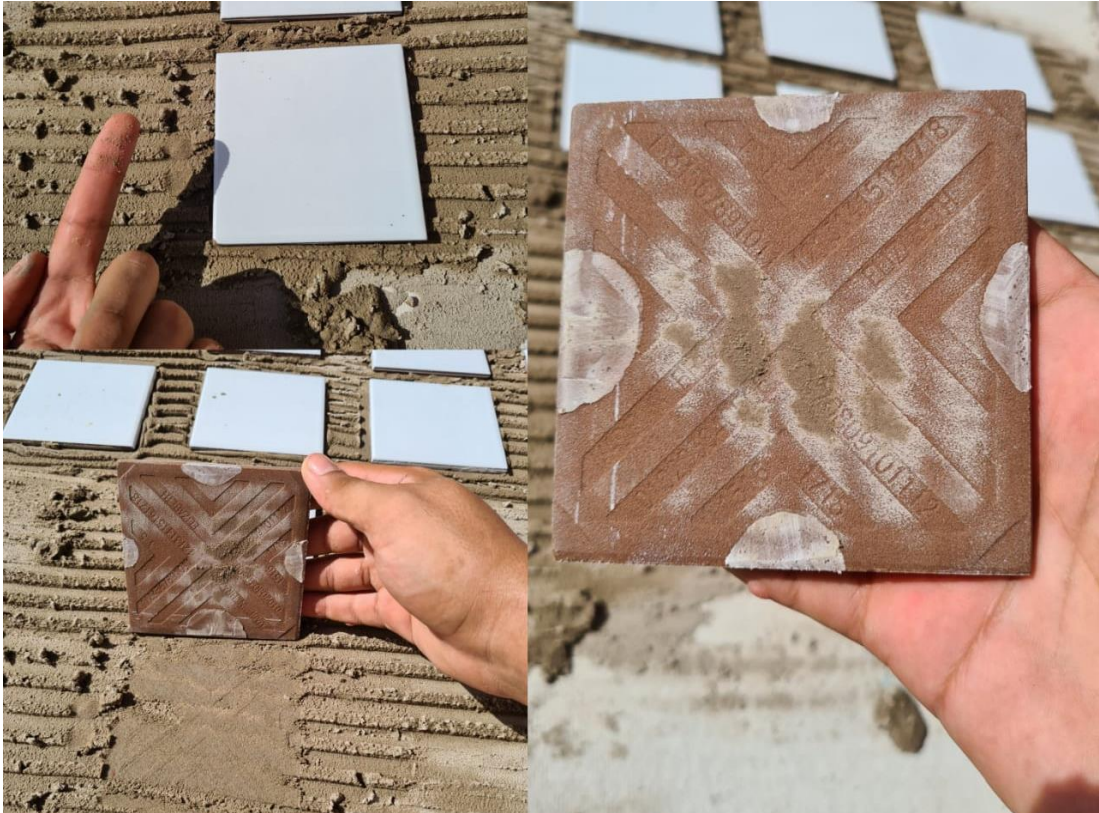
Figura 36: Ensaio Assentamento Cerâmico In Loco aos 13min
