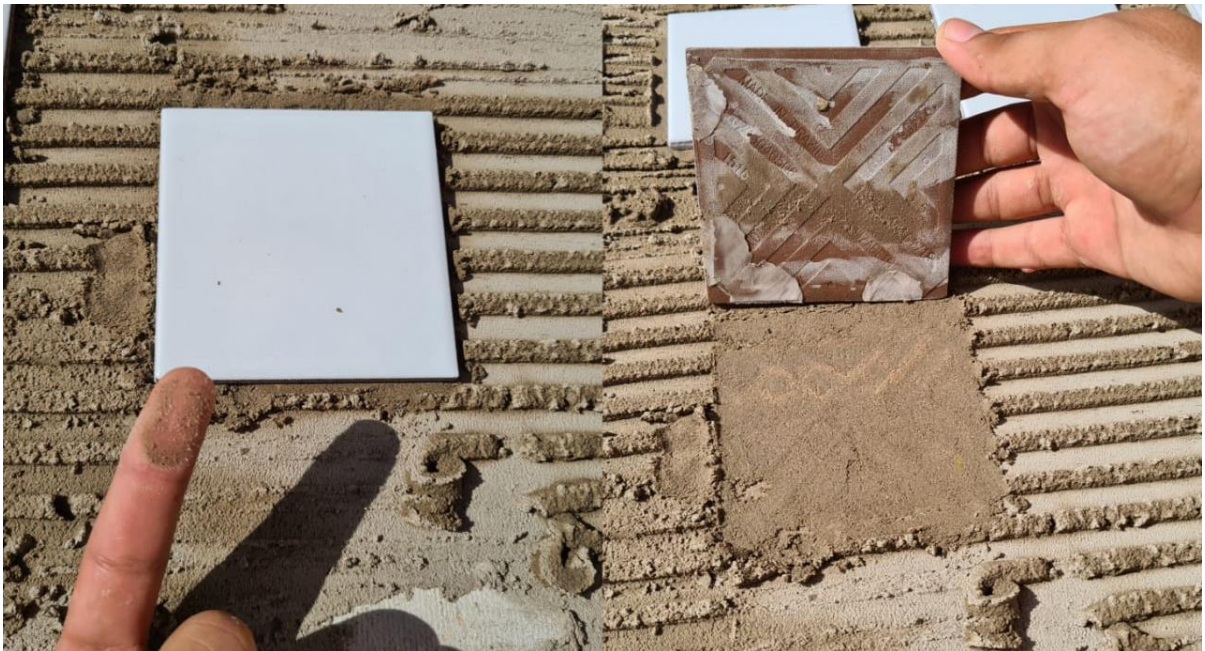
Figura 37: Ensaio Assentamento Cerâmico In Loco aos 15min
