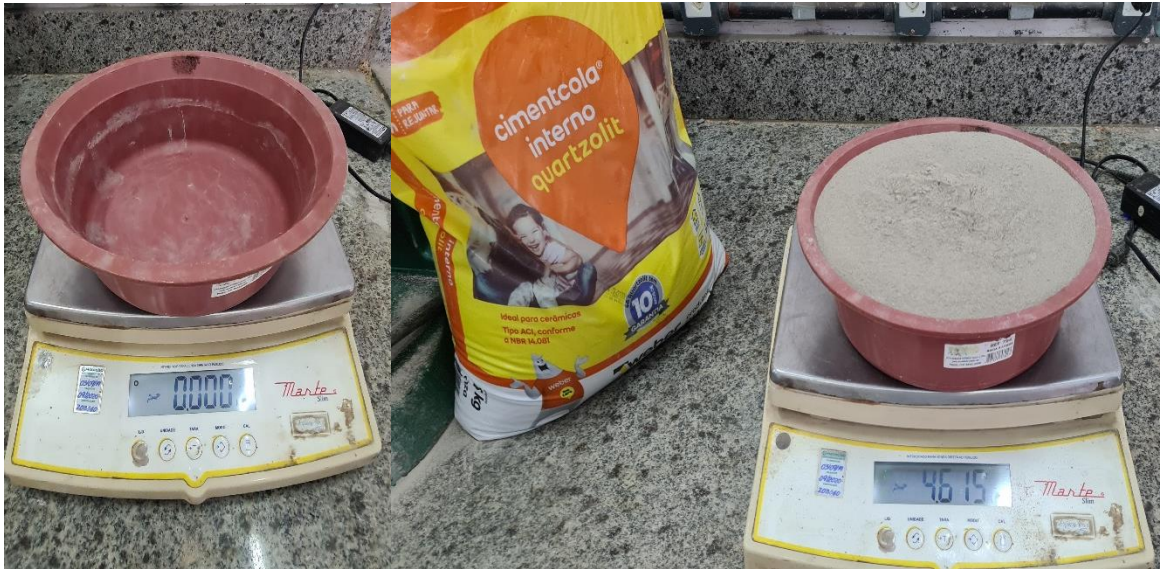
Figura 12: Dosagem da Argamassa colante Industrializada para Ensaio Laboratorial
