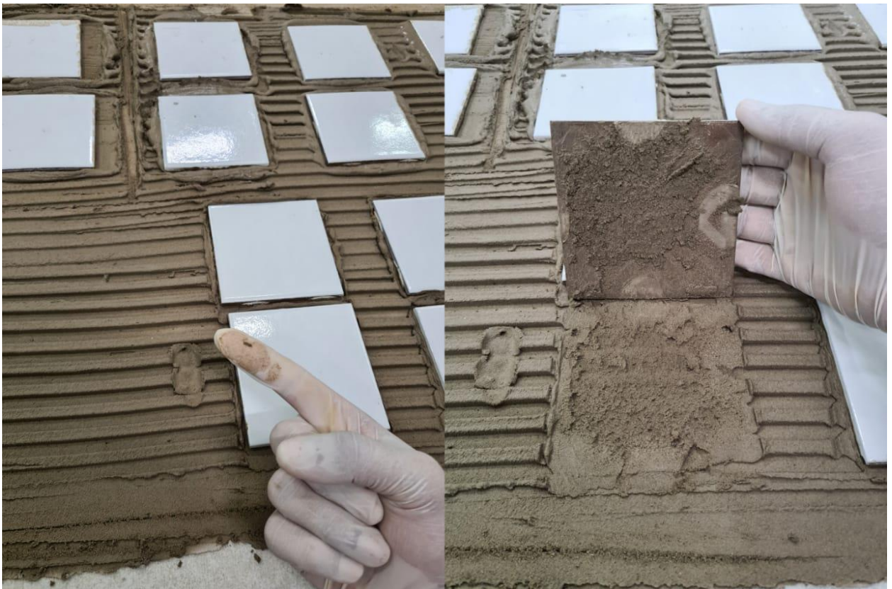
Figura 24: Ensaio Assentamento Cerâmico aos 50min
