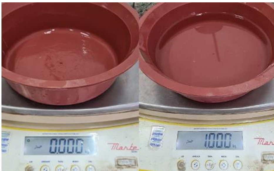
Figura 11: Dosagem da Água de Amassamento para Ensaio Laboratorial
