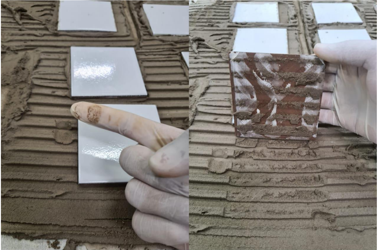
Figura 25: Ensaio Assentamento Cerâmico aos 70min
