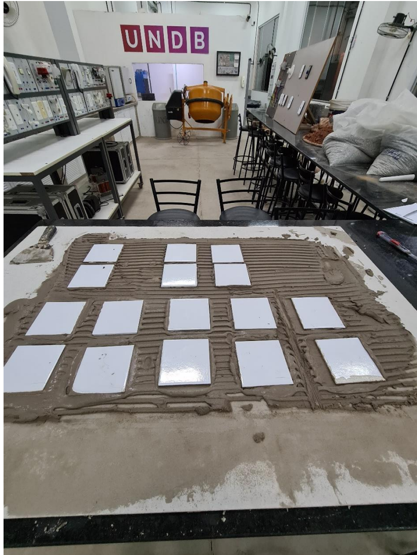
Figura 26: Ensaio Assentamento Cerâmico em Laboratório
