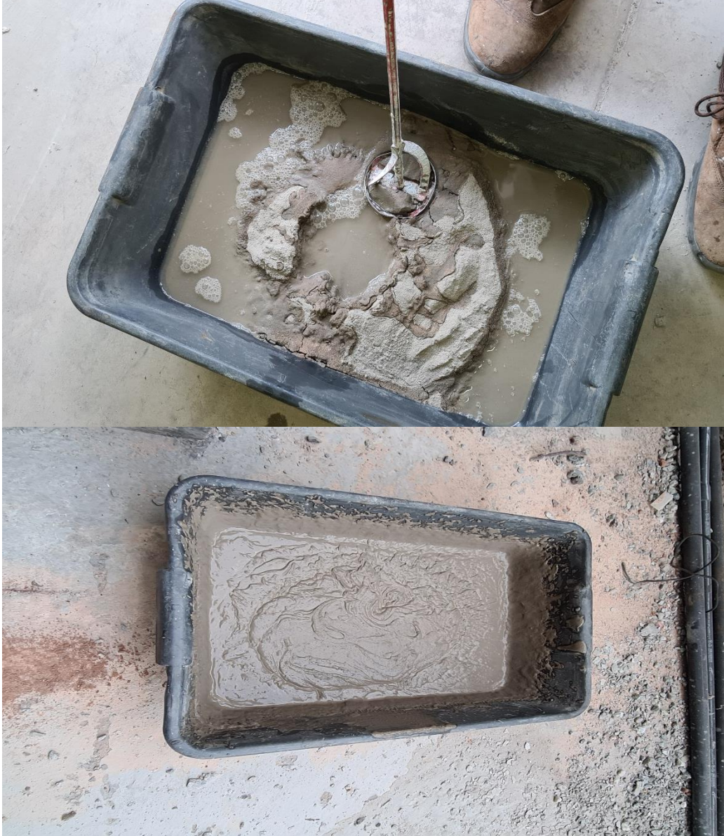
Figura 14: Adição de Água e Mistura à Argamassa Colante para Ensaio Laboratorial
