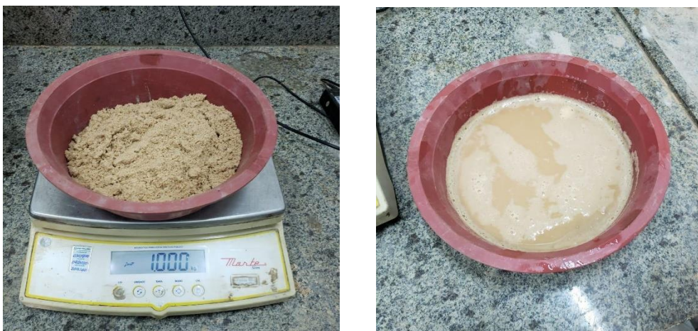
Figura 6: Pesagem e saturação do agregado.
