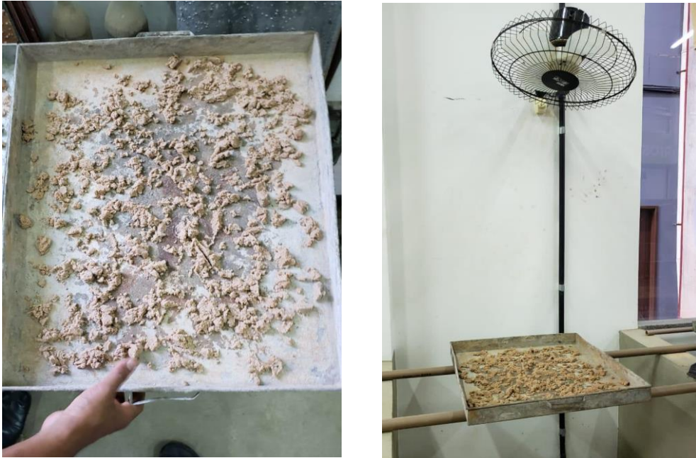
Figura 7: Espalhamento do material e exposição a uma corrente de ar.
