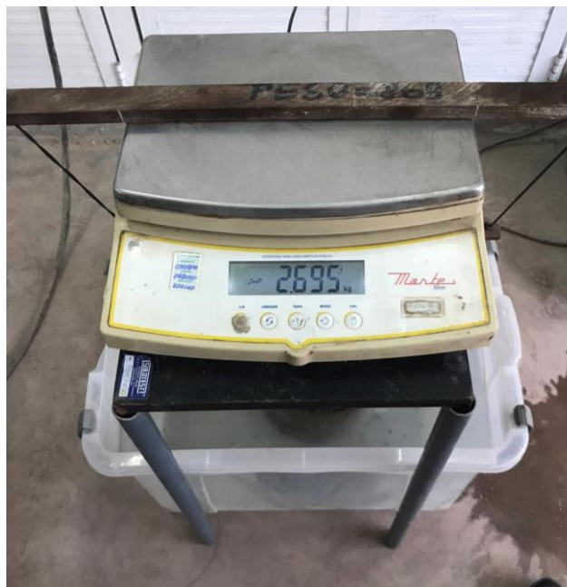
Figura 17: Pesagem hidrostática da amostra.
