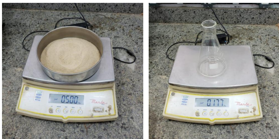
Figura 9: Pesagem de 500g da amostra e peso do frasco.
