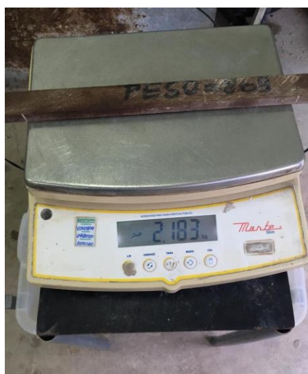
Figura 25: Massa da amostra imersa em água.
