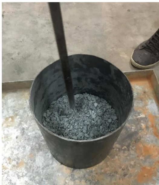
Figura 21: Adensamento da primeira camada.
