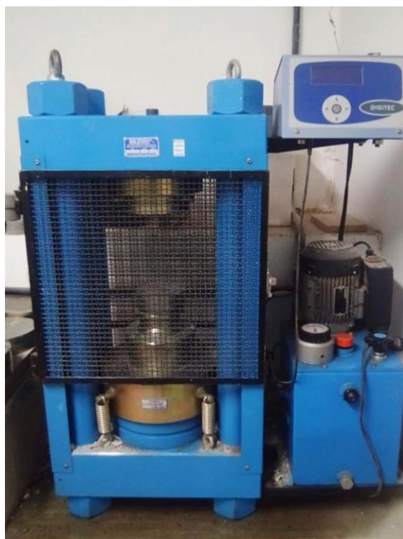
Figura 39: Máquina de ensaio de resistência a compressão.
