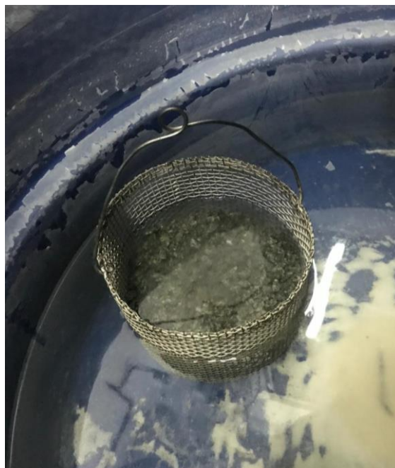
Figura 14: Submersão da amostra na água.
