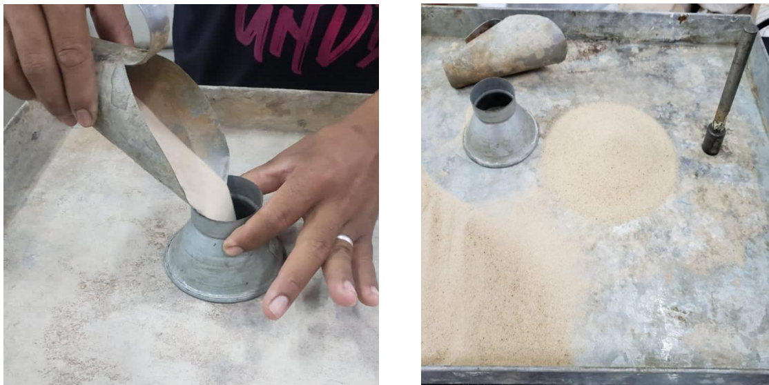
Figura 8: Preenchimento do tronco de cone e desmoronamento do agregado.
