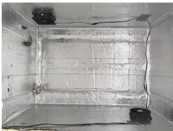
Figura 29: Ventiladores tipo cooler posicionados no recipiente.
