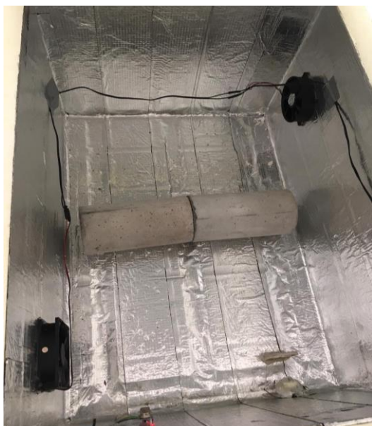
Figura 35: (a) Corpos de prova posicionados no interior da câmara; (b) Vedação da caixa com silicone e fita adesiva.
