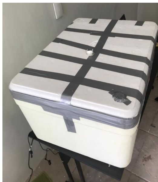
Figura 35: (a) Corpos de prova posicionados no interior da câmara; (b) Vedação da caixa com silicone e fita adesiva.
