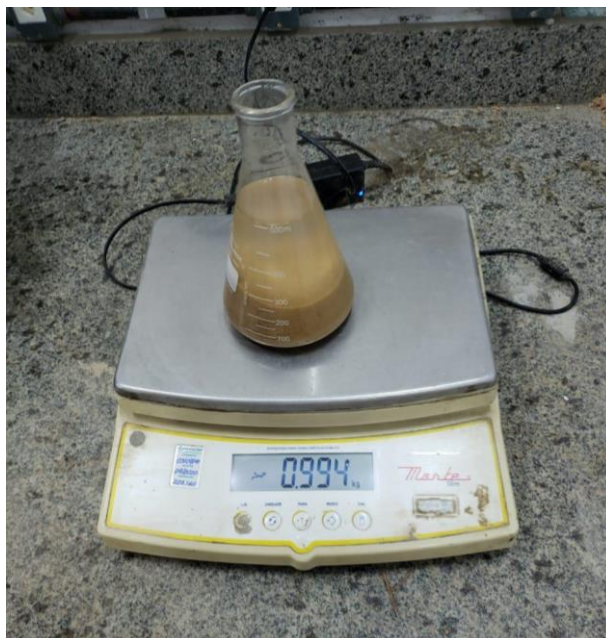
Figura 10: Peso do conjunto agregado + água.
