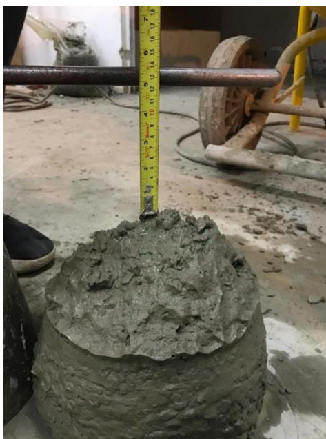
Figura 37: Medição do abatimento de tronco de cone.
