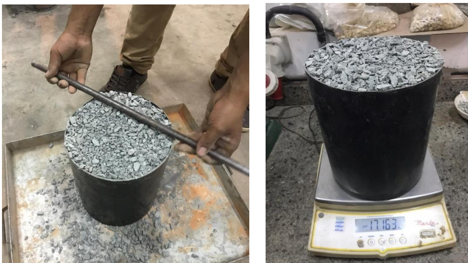
Figura 23: Arrasamento da camada superficial e massa do agregado.
