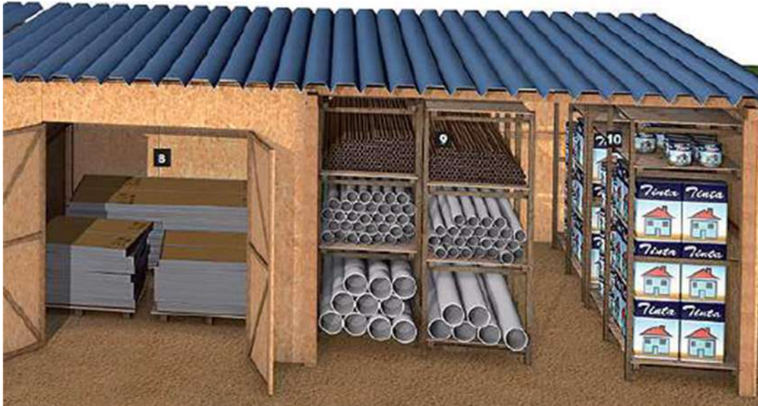
Figura 27 - Estocagem de materiais
