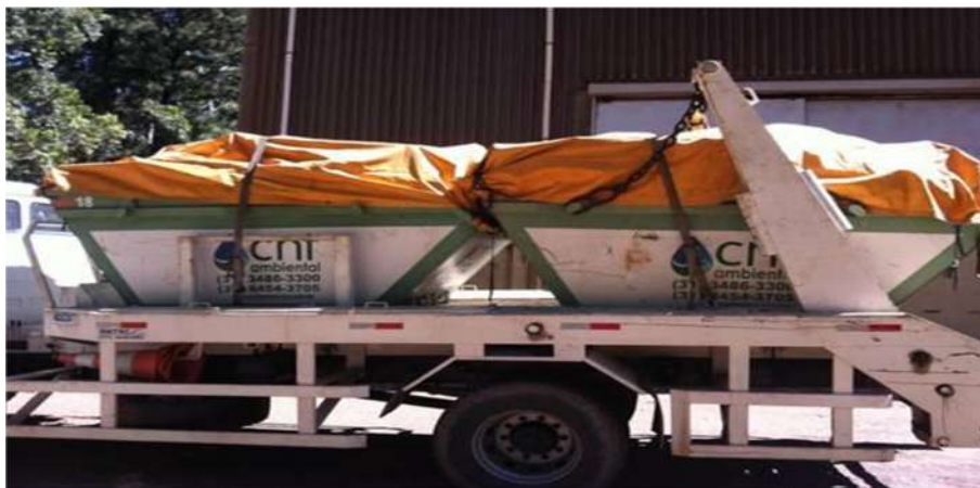
Figura 20 - Transporte de resíduos com lonas
