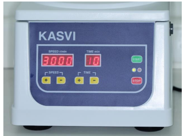
Figura 2: Centrifuga configurada para produção do L-PRF conforme o protocolo estabelecido por Choukroun
