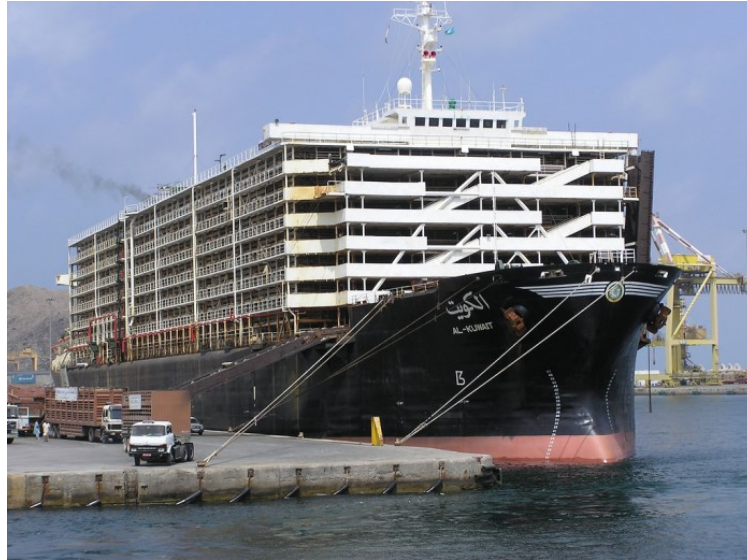
Imagem 3: Navio curral aberto atracado em porto. É possível observar a nova casa de comando à frente, e a antiga atrás, de antes de ser adaptado para navio curral
