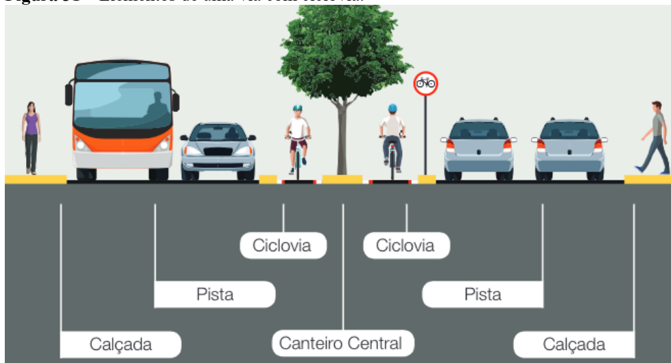
Figura 31 – Elementos de uma via com ciclovias.
