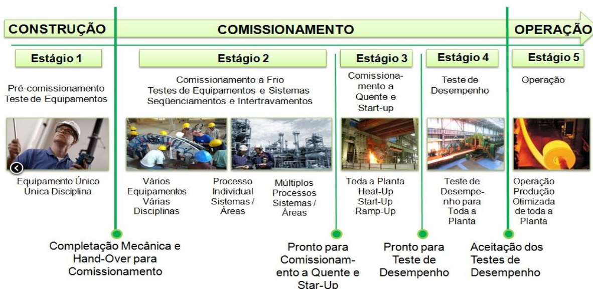
Figura 2 – Principais pontos para o Comissionamento: Completação Mecânica, Comissionamento a Frio, Comissionamento a Quente, Teste de Desempenho, Aceitação dos Testes
