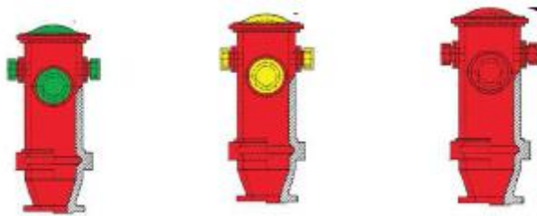
Figura 9 - Hidrantes de coluna
